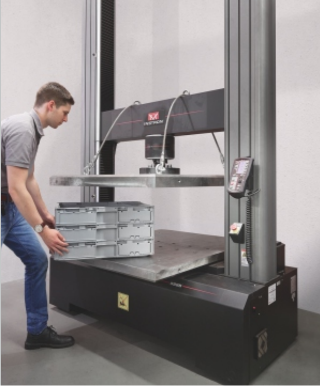
Uniwersalna maszyna wytrzymałościowa z naciskiem do 250 kN.
