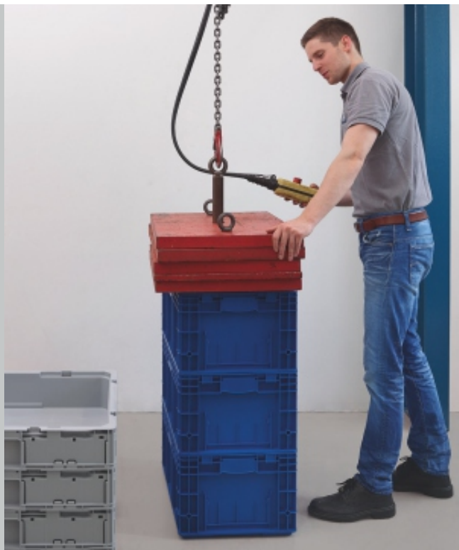
Urządzenie dźwigowe do przeprowadzania statycznych testów obciążeniowych.
