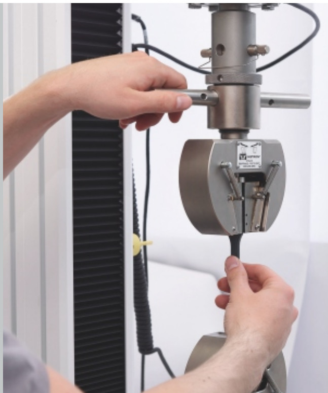
Uniwersalna maszyna wytrzymałościowa do przeprowadzania prób rozciągania do 30 kN.
