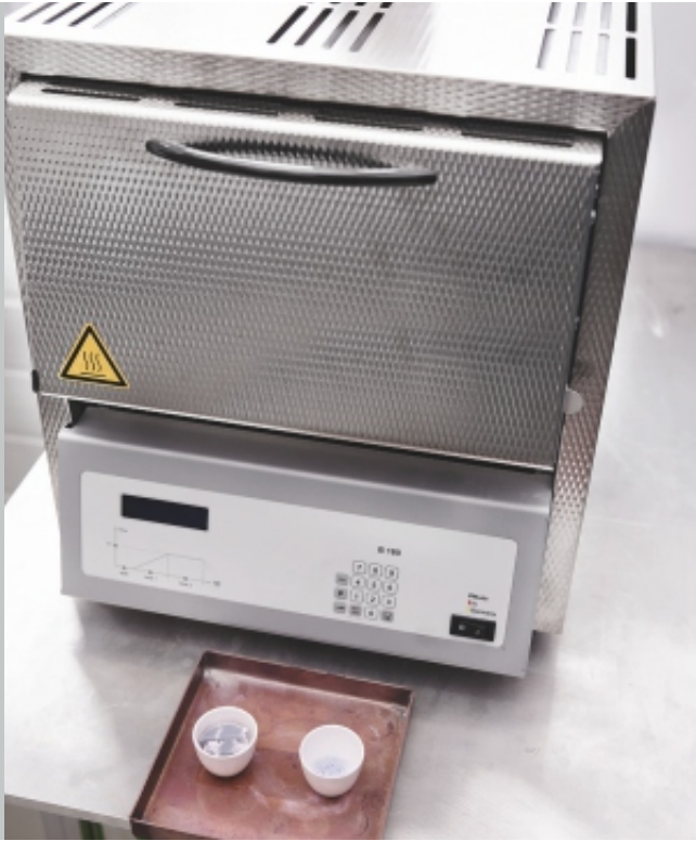
Piec do spopielenia służący do ustalania zawartości części organicznych.
