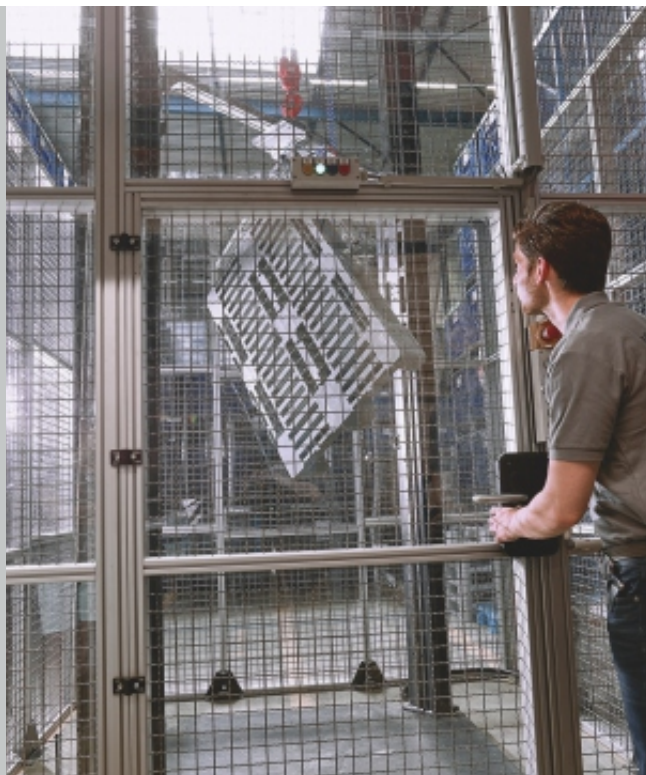
Instalacja dla przeprowadzania badań w swobodnym spadku z wysokości do 4 metrów.
